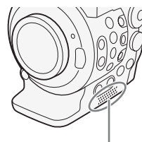
Entradas de ventilación
